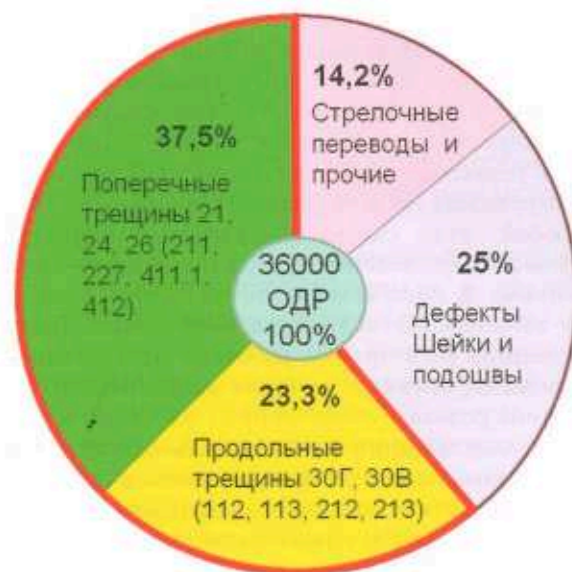
Рис. 9. Доля дефектов головки рельсов от общего количества обнаруженных
