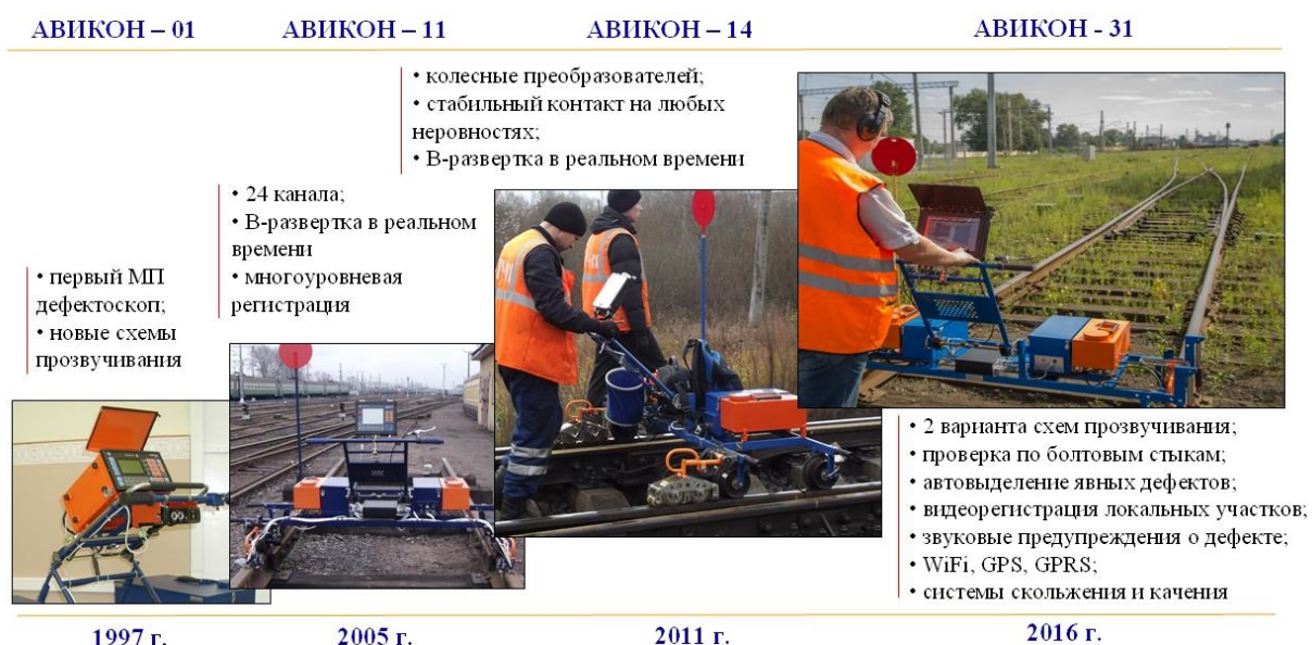
Рис. 1. Съемные микропроцессорные (МП) дефектоскопы – этапы развития
