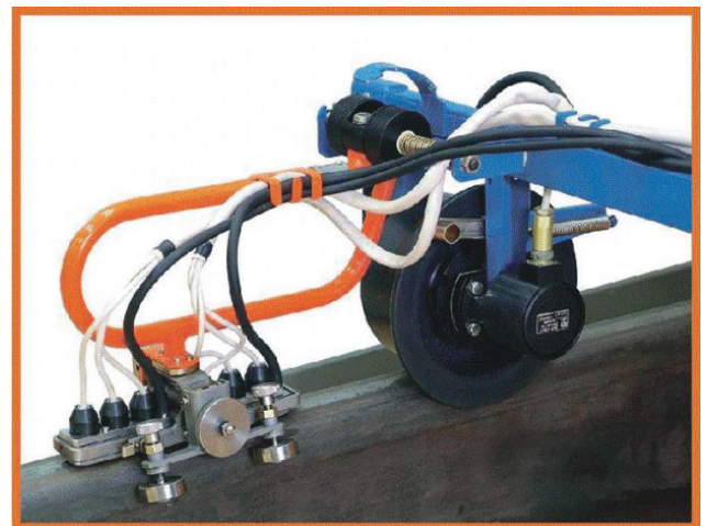
«Искательная система с полуавтоматической центровкой»
