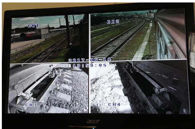
Видеоконтроль инфраструктуры обзорными камерами
