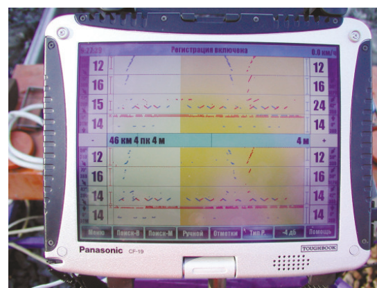
Режим «В-развертка» - выявление дефектов непосредственно в пути, не дожидаясь расшифровки дефектограмм
