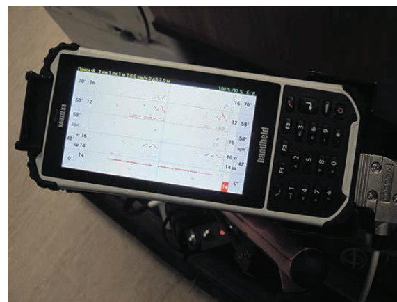
Блок управления и индикации на базе компактного защищенного ПК
