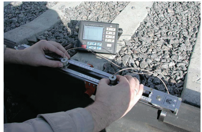
Контроль алюминотермитной сварки дефектоскопом АВИКОН-02Р зеркальным методом при помощи сканера САТС-02Р.
