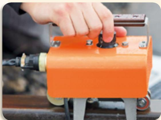
Сканер для контроля головки рельса с получением 3D-изображения
