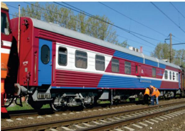
Вагон-дефектоскоп с дефектоскопическим комплексом **АВИКОН-03М** для скоростного контроля рельсов на базе ультразвуковых, магнитных и оптических методов контроля
