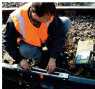
Дефектоскоп **АВИКОН-02Р** для контроля сварных стыков и отдельных сечений рельсов в полевых и стационарных условиях
