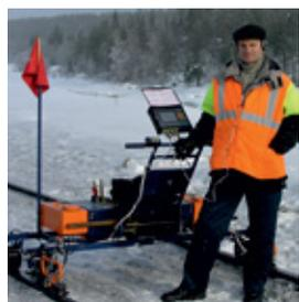
Дефектоскопы **АВИКОН-11** для сплошного контроля рельсов с системой регистрации сигналов
