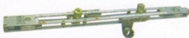
Рис. 10. Сканер SATC-02P ультразвукового дефектоскопа АВИКОН-02P [16]
