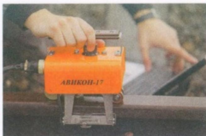
Рис. 9. Сканер ультразвукового дефектоскопа-томографа АВИКОН-17
