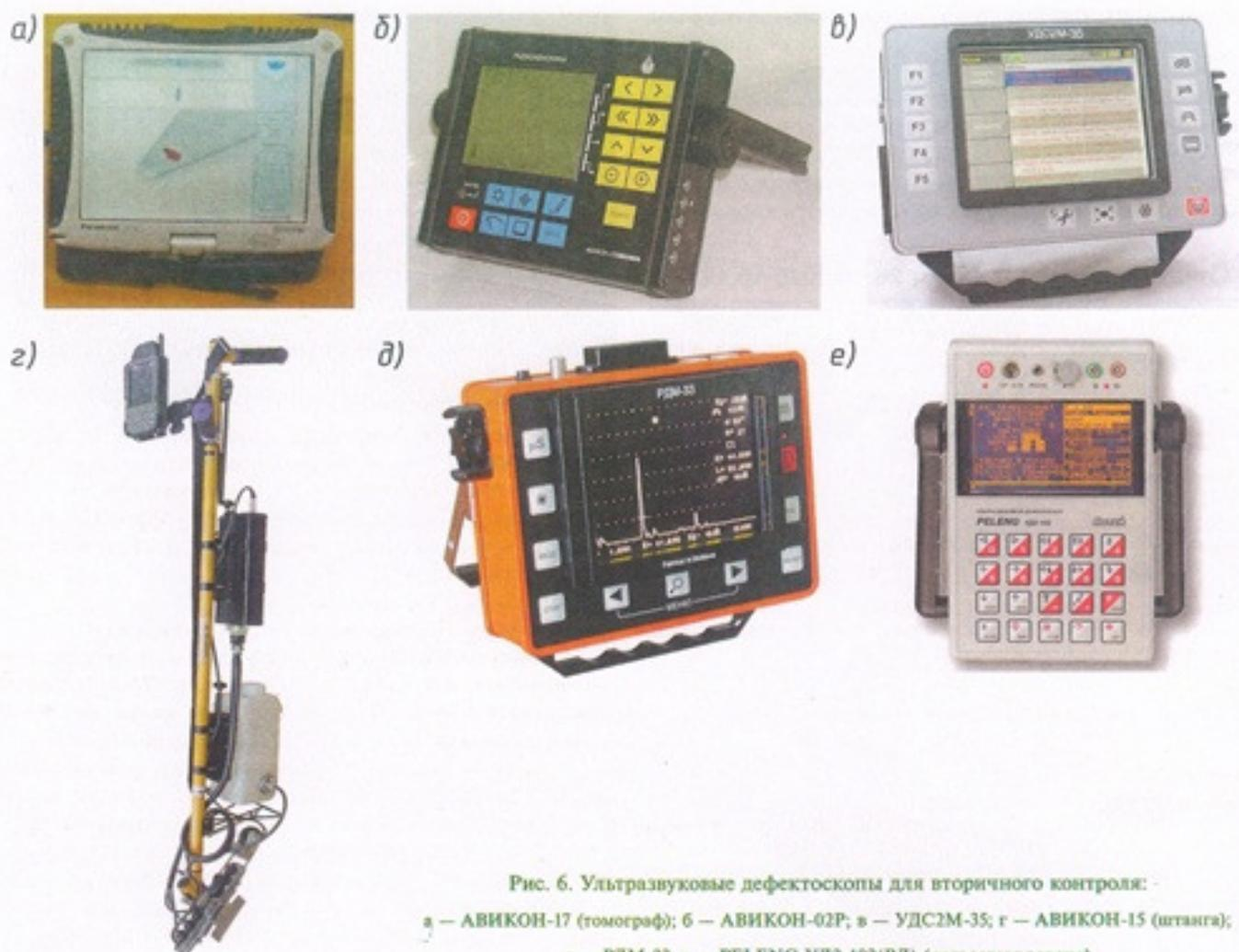
Рис. 6. Ультразвуковые дефектоскопы для вторичного контроля:
