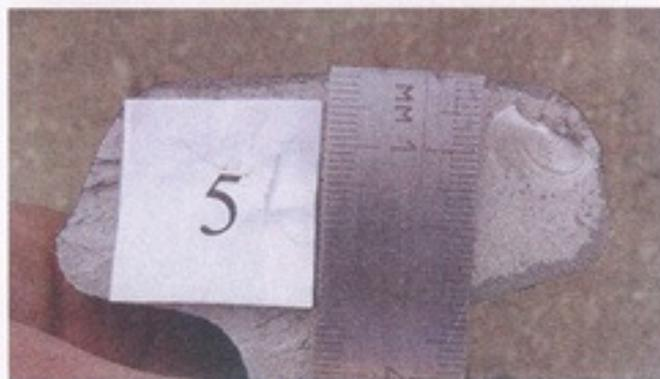
Рис. 7. Дефект 21.2 был выявлен в пути зеркальным методом по схеме РОМБ+ и подтвержден дефектоскопом АВИКОН-17. Дефектоскопом УДС2М-35, реализующим эхо-метод, дефект не подтвердился
